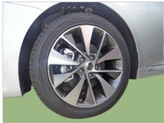
拆卸车轮和轮胎时小心不要损坏轮毂螺栓。
